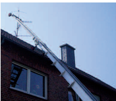
Klaas élévateurs avec genouillère
