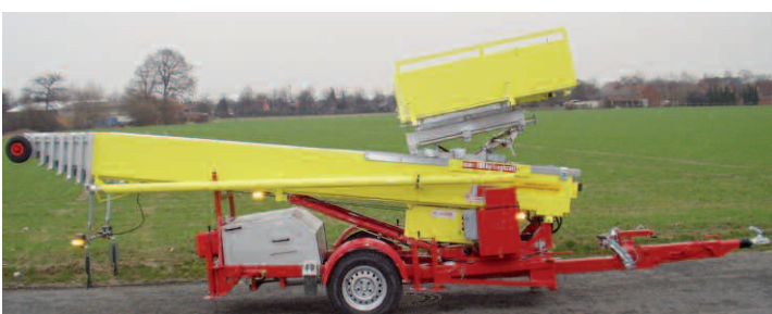
Klaas élévateurs avec genouillère
