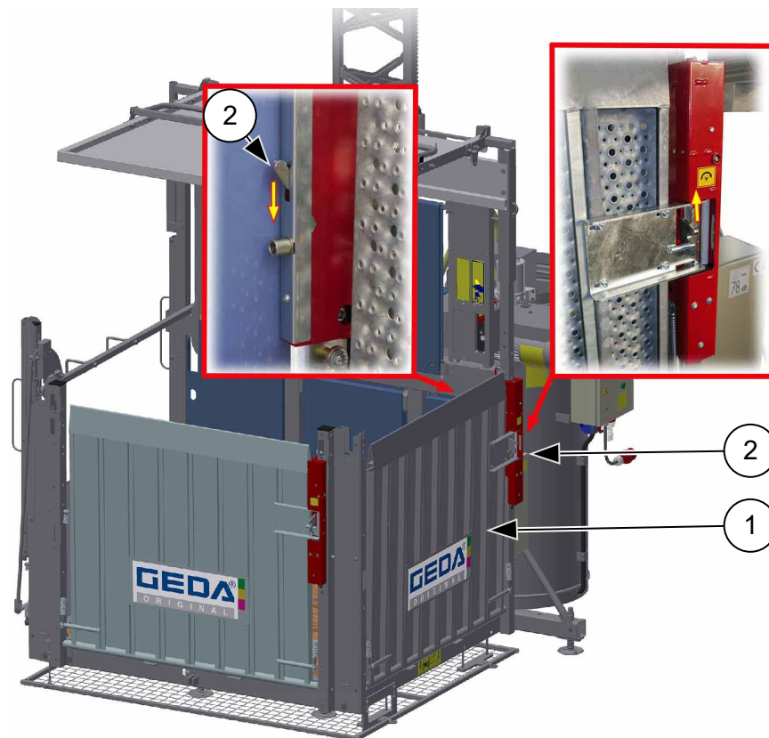
III. 26 – Verrouillage Porte de chargement / Rampe
