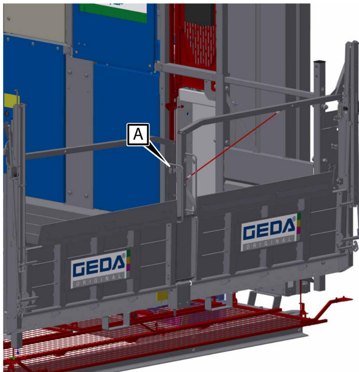
III. 17 – Barrière avec rampe de chargement
