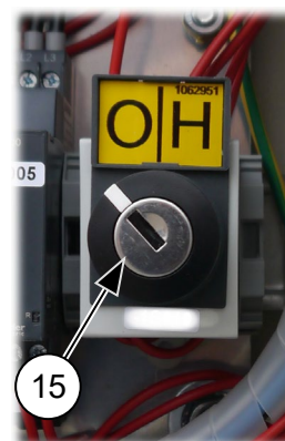
III. 32 – Interrupteur Aller-Retour
