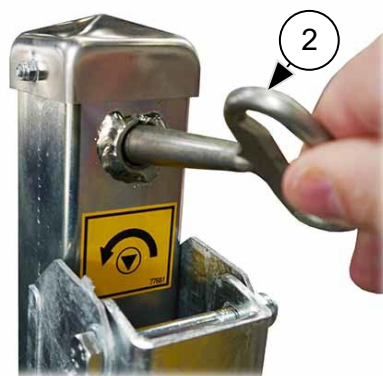
III. 56 – Déverrouillage d'urgence de la barrière avec verrouillage électromécanique
