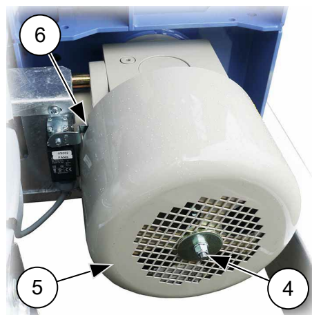
III. 103 – Dispositif de freinage avec interrupteur de fin d'urgence
