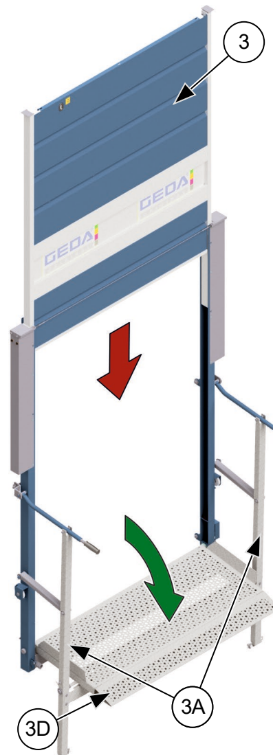
III. 13 – Vue extérieure de la porte coulissante verticale
