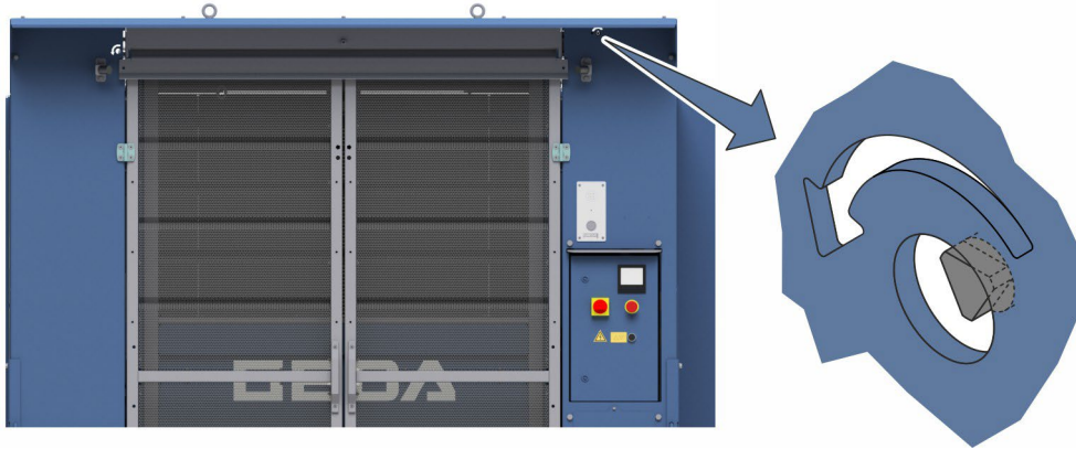
III. 11 – Déverrouillage d'urgence des battants d'accès
