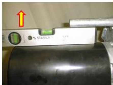
III. 58 – Contrôle du bobinage du câble d'acier
