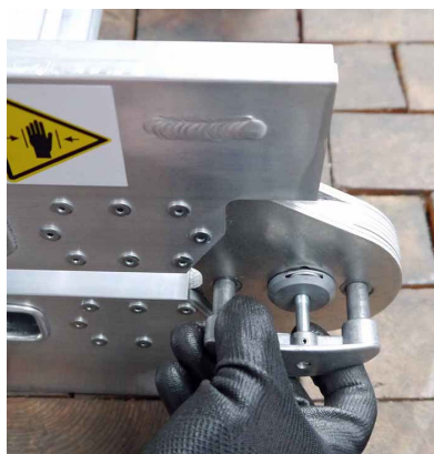
III. 14 – Retrait du dispositif de blocage de l'échelle
