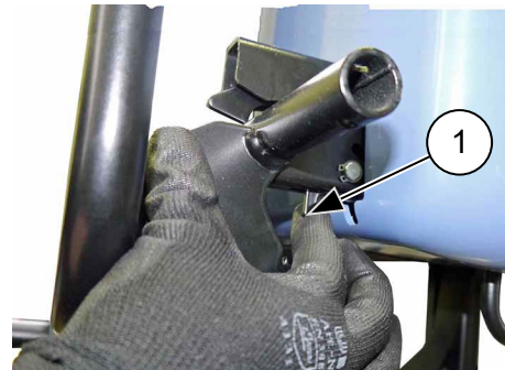
III. 80 – Verrouillage du logement
