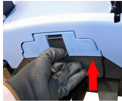
III. 55 – Introduire l'accu sur l'appareil de base
