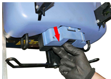
III. 89 – Démontez l'accu
