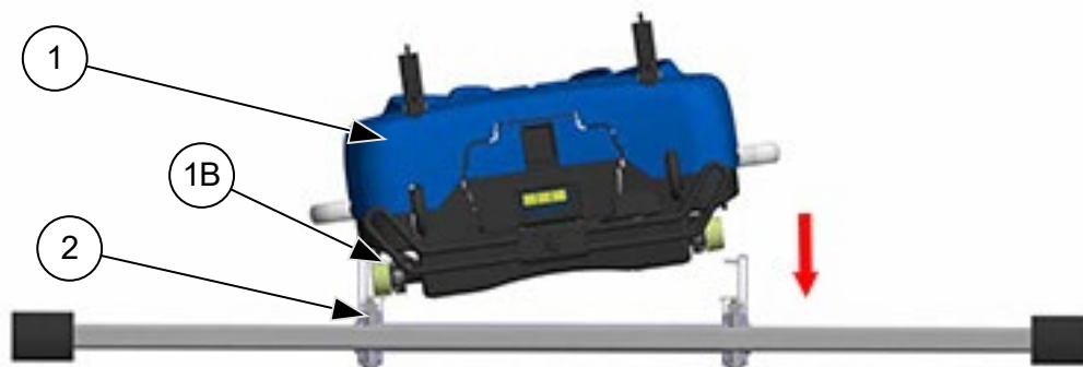
III. 42 – Montage de l'appareil de base sur l'échelle
