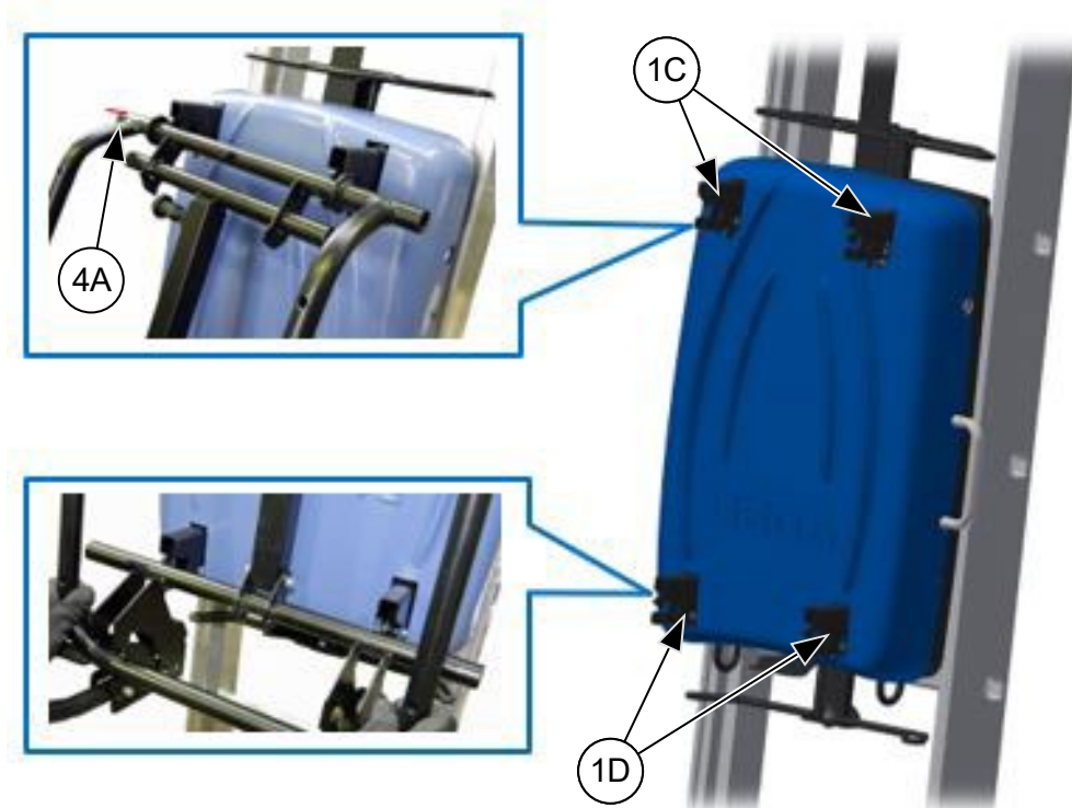
III. 46 – Montage de la plateforme de charge
