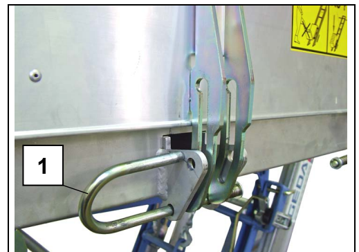
Fig. 20 Ouvrir le verrouillage de la ridelle
