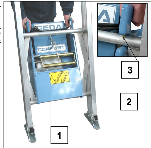
Fig. 37 Mise en place du treuil
