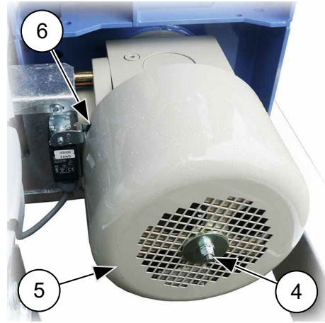
III. 79 – Dispositif de freinage avec interrupteur de fin d'urgence
