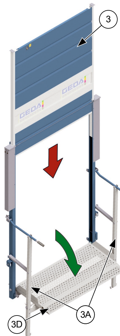
Abb. 7: Vertikale Schiebetür von außen
