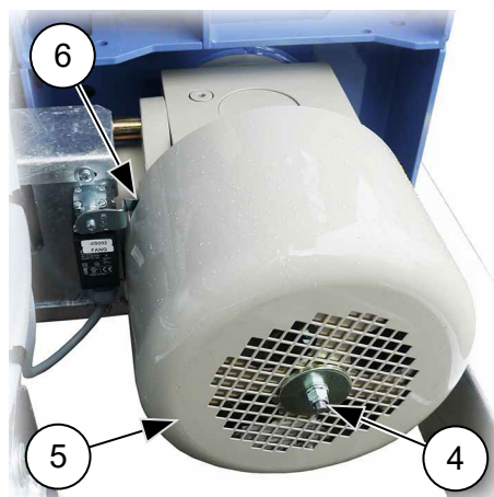
Abb. 79: Fangvorrichtung mit Endschalter
