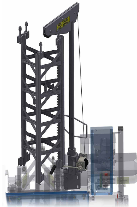
Abb. 60: Anheben, Positionieren von Mastteilen
