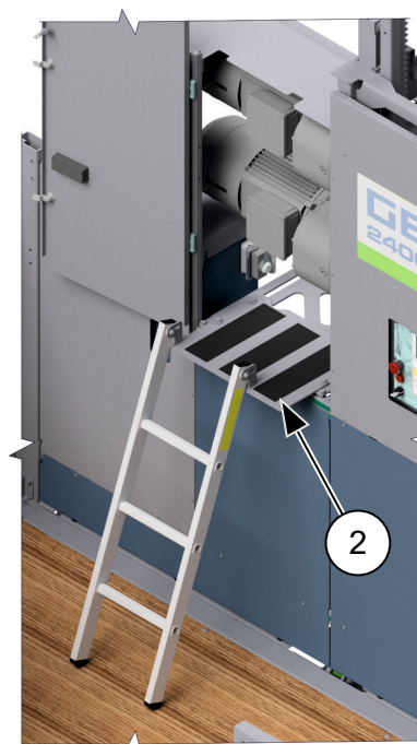
III. 62 – Plateforme de montage supplémentaire
